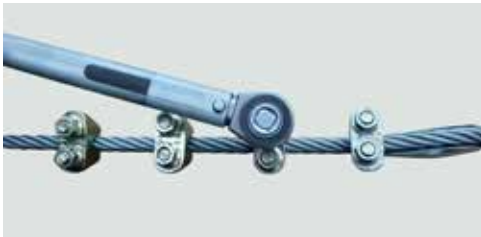
Abb. 12: Anziehen der Schrauben mittels Drehmomentschlüssel
