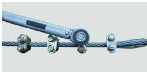
Rys. 12: Dokręcenie nakrętek kolnierzowych kluczem dynamometrycznym
